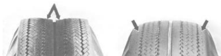
Gambar 28. Aus Pada Tengah Tread dan Pada Shoulder
